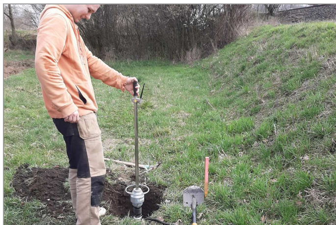
foto 12: Rázová zatěžovací zkoušky RZ1 v kopané sondě
