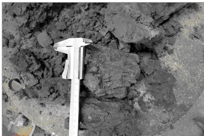
foto 14: Detail slabě diageneticky zpevněného jílovce z vrtu J-2
